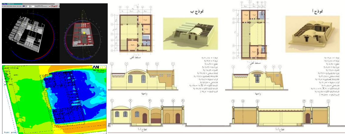
(شكل ١١) التصميم المعماري للوحدات السكنية طبقاً لتطوير المفردات المعمارية التقليدية المحلية بمنطقة المشروع مع عمل نماذج محاكاة بالحاسوب لدراسة الظلال وحركة الهواء في أوقات مختلفة
