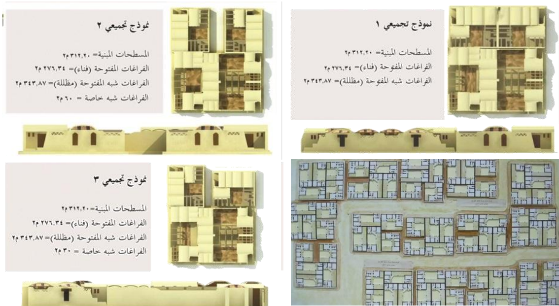
(شكل ١٢) تجميع الوحدات السكنية في بلوك العائلة وتشكيل وحدة النسيج العمراني بما يتماشى مع ما تم رصده من نسق النسيج العمراني التقليدي المحلى بمنطقة المشروع
